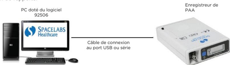
Figure 1-2 : Configuration de connexion directe à une interface d'ordinateur de bureau
